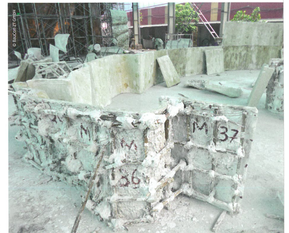
Anfertigung der Gipsformen, auf denen die Kupferhülle in Form geklopft wurde
