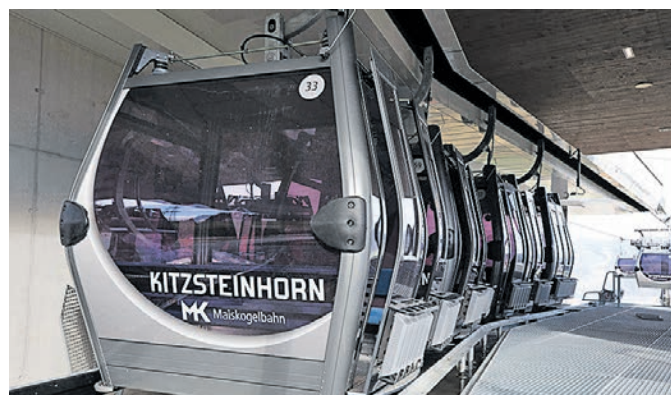
Die neue MK Maiskogelbahn ist startbereit: Am 14. Dezember eröffnet die neue 10er-Einseilumlaufbahn, gebaut vom Südtiroler Seilbahnspezialisten Leitner.
